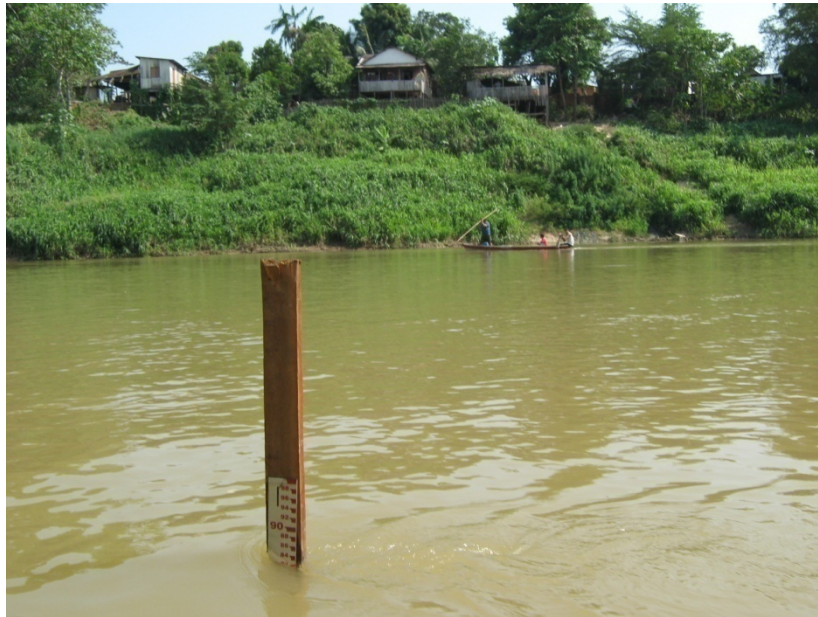
Figura 4. Falta do número de identificação em um lance das réguas limnimétricas.
